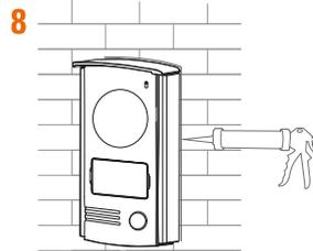
Après installation et test, placer un joint silicone transparent sans acide sur le haut et les côtés de la platine de rue (pas sur le bas) pour éviter tout risque d'infiltration.
